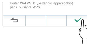
Il collegamento tra la postazione principale di monitoraggio e il router wireless viene stabilita automaticamente. (In alcuni casi, potrebbe essere necessario toccare  prima di premere il tasto WPS sul router wireless.)
